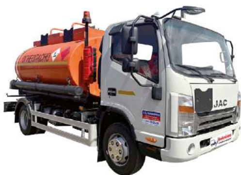
N90 Автоопливозаправщик Объем 6 м 3 Двухсекционный
