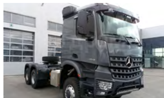
MERCEDES-BENZ AROCS 3348 AS , дизель, 6x6, 12.8 л, 476 л.с, г/п 120 т, КПП робот.
