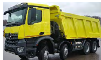
MERCEDES-BENZ AROCS 4145 K , дизель, 8x4, 12.8 л, 476 л.с, г/п 33 т, КПП робот.
