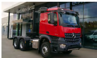
MERCEDES-BENZ AROCS 3348 S , дизель, 6x4, 12.8 л, 476 л.с, г/п 120 т, КПП робот.
