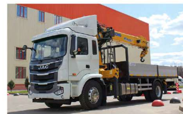
N200 6,7 л, турбодизель ISD285 50 стандарта Евро-5, 8МКПП. Подвеска рессорная.
