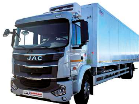
N200 6,7 л, турбодизель ISD285 50 стандарта Евро-5, 8МКПП, г/п до 10 000 кг.
