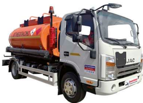
N90 Автоопливозаправщик Объем 6 м³ Двухсекционный
