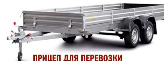
ПРИЦЕП «КРЕПЫШ» Масса/грузоподъемность: 750/565 кг Габаритные размеры: 3065x1710x1350
