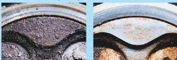
Камера сгорания ДО и ПОСЛЕ
