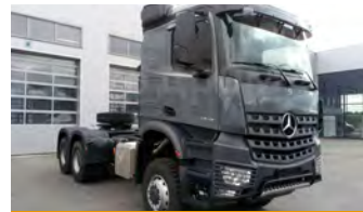
MERCEDES-BENZ AROCS 3348 AS , дизель, 6х6, 12.8 л, 476 л.с, г/п 120 т, КПП робот.
