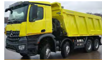
MERCEDES-BENZ AROCS 4145 K , дизель, 8х4, 12.8 л, 476 л.с, г/п 33 т, КПП робот.
