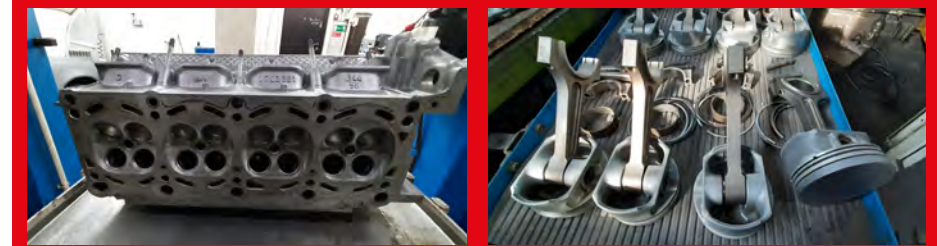
ДВИГАТЕЛЬ ПОСЛЕ КАПИТАЛЬНОГО РЕМОНТА
